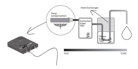
엘로치오의 4H 시스템은 추출 보일러, 스팀 보일러, PRE-HEAT System 그룹에드, 총 네개의 가열구간 구조를 통해 설계하여 열손실이 발생할 수 있는 구간을 최소화 합니다.
